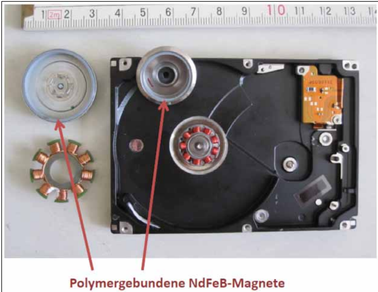
Abbildung 8 Polymergebundene NdFeB-Magnete von Gleichstrommotoren in optischen Laufwerken (links) und Festplatten (rechts).
