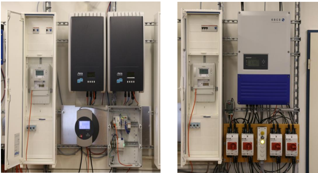
Abbildung 1: Testplätze des Smart Grid Testlabors mit iMSys und Wechselrichtern
