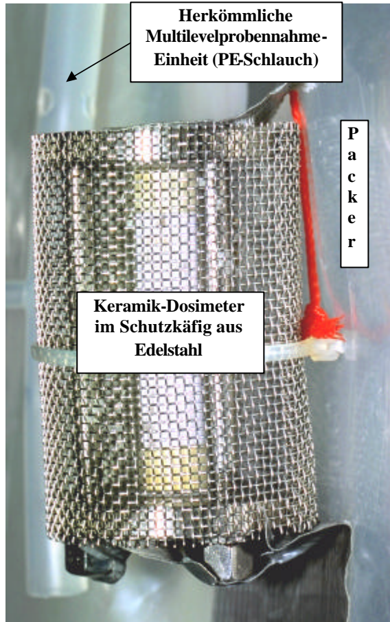
Abb. A.4: Befestigung des Keramikdosimeters im Edelstahl-Schutzkäfig am Multilevel-Packersystem.
