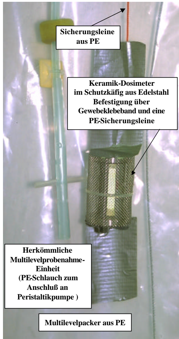
Abb. A.3: Befestigung des Keramikdosimeters im Edelstahl-Schutzkäfig bzw. Abstandshalter am Multilevel-Packersystem.
