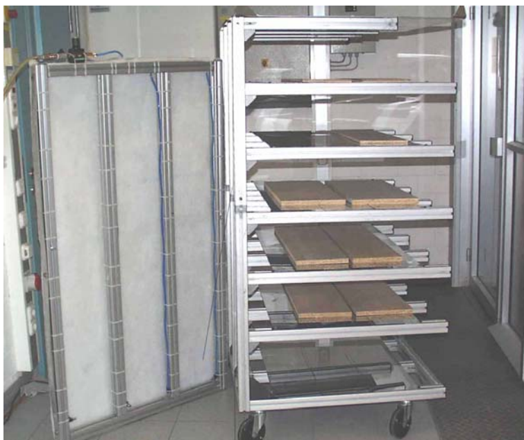
Abb. 18: Belüfteter Hordenwagen zur Trocknung von wasserlackbeschichteten Flachteilen mittels strömender Luft (Prototyp Fraunhofer IPA)
