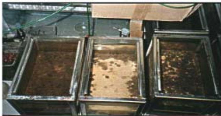
Abb. 3.1.1.1c: Vergleich der Intensität der Bioturbation in den Aquarien mit 1 cm (links), 2 cm (Mitte) und 2.5 cm (rechts) hohen Kalzitbarrieren vier Monate nach Aufbringung.
