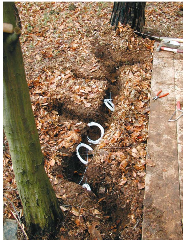
Saugkerzeneinbau in 10 cm Tiefe an der Messstelle Forst
