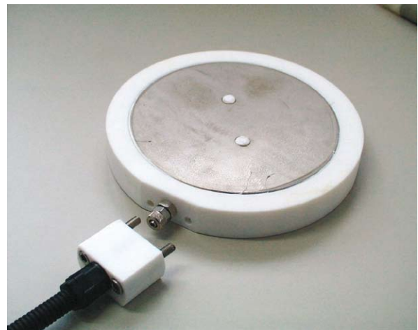
Plattenlysimeter mit Teflonkörper und Saugplatte aus V2A-Edelstahl
