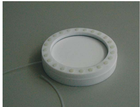
Plattenlysimeter mit Teflonkörper und Nylon-Doppelmembran
