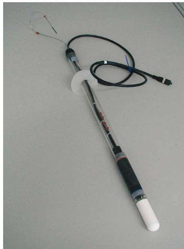
Tensiometer T8, Fa. UMS mit externer Befüllung
