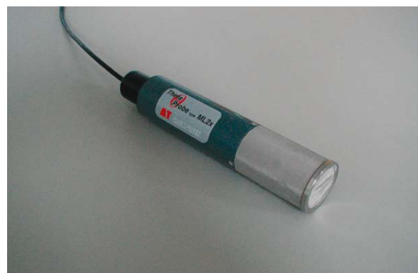
Equitensiometer, Dr. Liu (FDR-Sonde mit porösem Ausgleichkörper)
